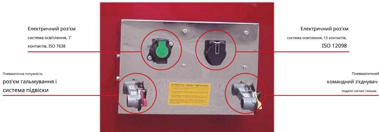
МАЛЮНОК 2: Електричні та пневматичні з'єднання
