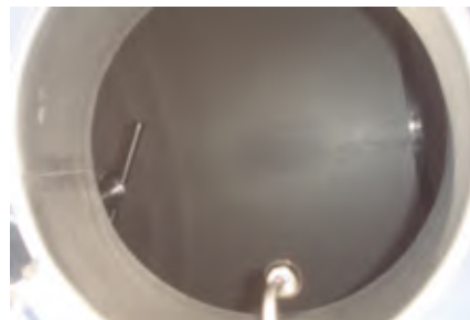
МАЛЮНОК 20: Душ для внутрішнього очищення з датчиком переливу
