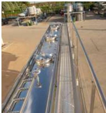
МАЛЮНОК 19: З'єднання для верхнього очищення
