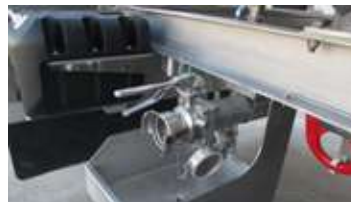
МАЛЮНОК 25: Загальний колектор із ручним випускним клапаном ззаду
